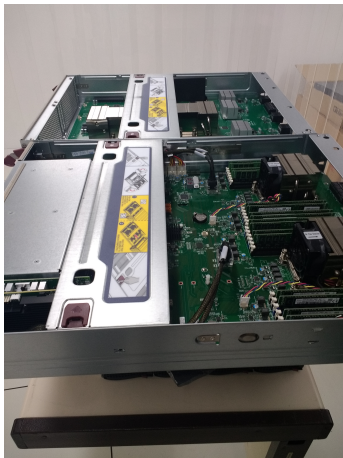
Figura: Vista interna de um servidor.
