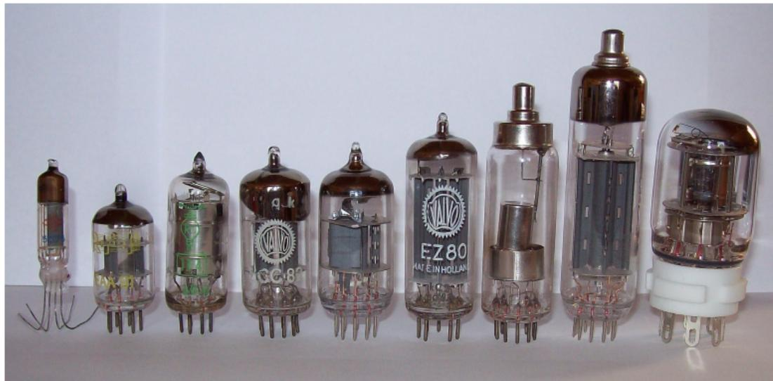
Figura: Válvulas a vácuo ou válvulas termiônicas. Fonte: Wikipedia
