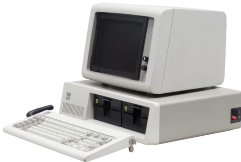
Figura: IBM PC com teclado e monitor. Fonte: Wikipedia
