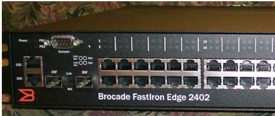
Figura: Switch com portas Ethernet RJ45 e portas SFP. Fonte: Wikipedia
