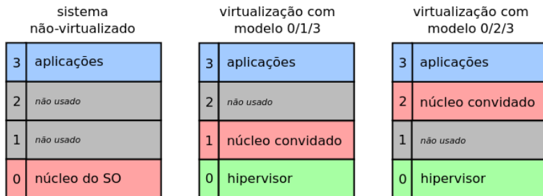
Figura: Níveis de proteção em processadores AMD/Intel. Fonte: CM 33
